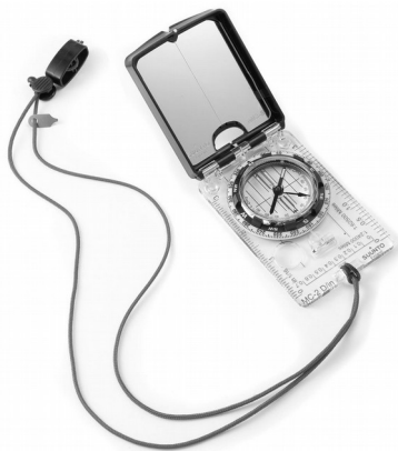
Bússola do tipo "Silva", excelente para ser usada junto com um mapa ou carta topográfica
